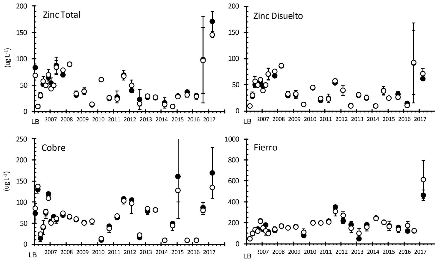
**FIGURA 3. PUERTO MEJILLONES.** Variabilidad temporal de los parámetros ambientales evaluados en el estrato superficial de la columna de agua de mar. Contraste de la concentración de metales pesados entre estaciones "referenciales y control" (círculos abiertos) y estaciones de monitoreo (círculos cerrados) del PSM. **MONITOREO MARZO 2017.** Media  $\pm$  DS. LB: Línea Base.
