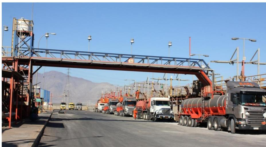
Adicionalmente, el sector de Andén de Carga puede ser utilizado para la transferencia de ácido hacia camiones, esto cuando existen ventanas de tiempo entre convoyes de ferrocarril. Para el control de despacho vía camiones, el sector de Andén de Carga cuenta con una báscula de pesaje dinámico, lo que permite controlar el peso total y peso por eje de cada camión que carga en dicho sector.
