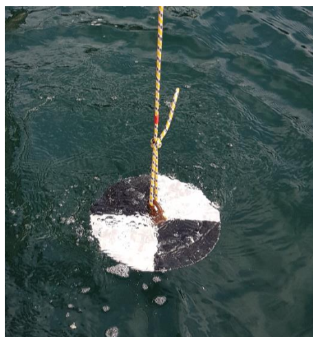
Figura 4.2. Medición de la transparencia utilizando disco Secchi. PVA Puerto Mejillones. Agosto 2019.
