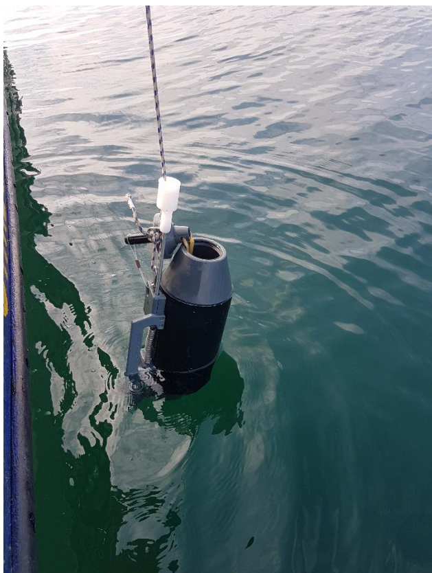
Figura 4.3. Obtención de muestras de agua de mar, mediante la utilización de una botella oceanográfica modelo Niskin. PVA Puerto Mejillones. Agosto 2019.
