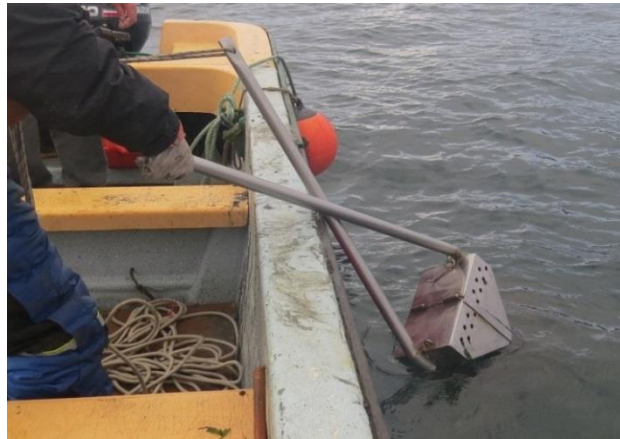
Figura 4.5. Muestreo de la matriz de sedimentos submareales con la draga van Veen. PVA Puerto Mejillones. Agosto 2019.
